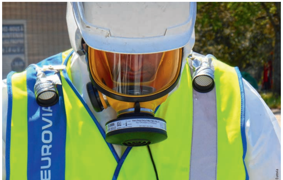
Photo 1 Équipement des opérateurs : pour permettre l'obtention de la sensibilité analytique de 1 fibre/litre sur la durée de l'intervention, chaque opérateur est équipé de deux systèmes de prélèvement.
