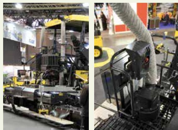
Un finisseur équipé d'un système d'aspiration des fumées (Photos EAPA)
